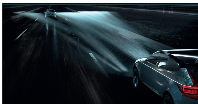
**Bild 2: Damit Fahrer:innen in entgegenkommenden Fahrzeugen nicht geblendet werden, schalten neue Multi-Pixel-LED-Scheinwerfer automatisch bestimmte Pixel aus.**
